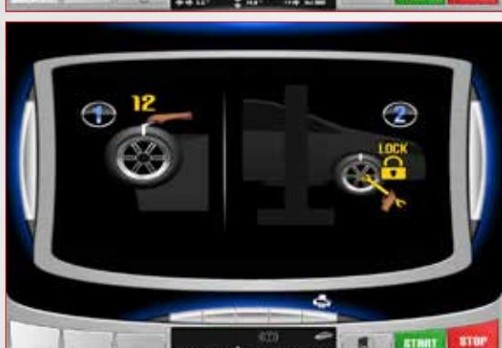
Sistema de diagnóstico da excentricidade radial da roda devido a vibrações que não podem ser resolvidas com o simples balanceamento.
